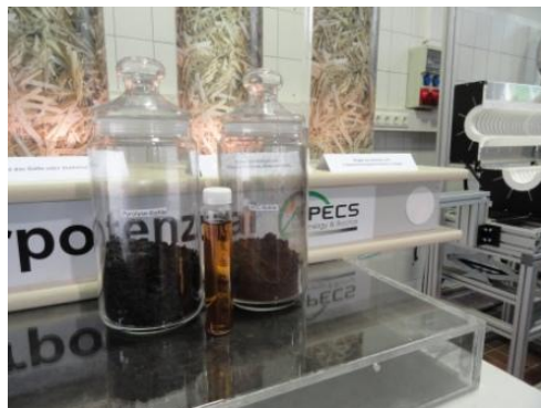
左 熱分解炉によるバイオ炭 中 熱水炭化炉 (HTC) から出る木酢液 右 熱水炭化炉によるバイオ炭
